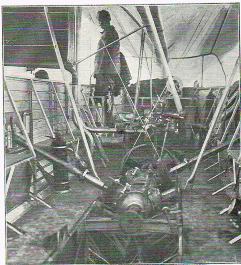
L'intérieur de la nacelle arrière, après l'enlèvement d'un de ses deux moteurs (Au premier plan, le quadruple embrayage.)
